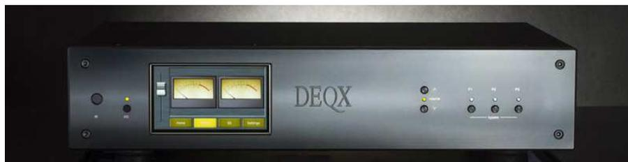
DEQX プロセッサ・プリアンプは、完璧に設計された DSP プラットフォームと特許取得の革新的キャリブレーション技術によって、スピーカーのひずみの多くを取り去り、リスニングルームの共鳴などによる音の濁りも最大限補正します。スピーカー測定によって、各周波数成分の時間誤差を補正し、すべての周波数成分がまったく同時に耳に届くようにします。そして周波数特性もフラットに補正します。さらに、リスニングルーム測定によって、部屋の形状やスピーカーの設置場所による共鳴などの問題を特に低域周波数に着目して解決します。
